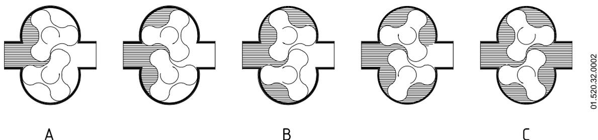
**A:** при вращении кулачков пространство со стороны всасывания увеличивается, поскольку один кулачок отдалекается от другого, создавая частичный вакуум, под воздействием которого жидкость перемещается в насосную камеру.
